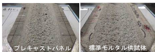
写真-18 供試体の摩耗状況
