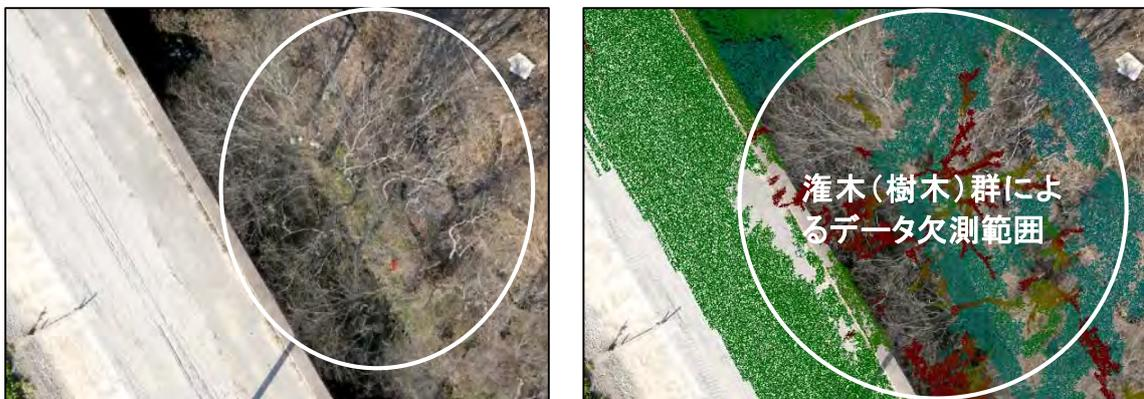
図5.8 灌木(樹木)群によるデータ欠測例
