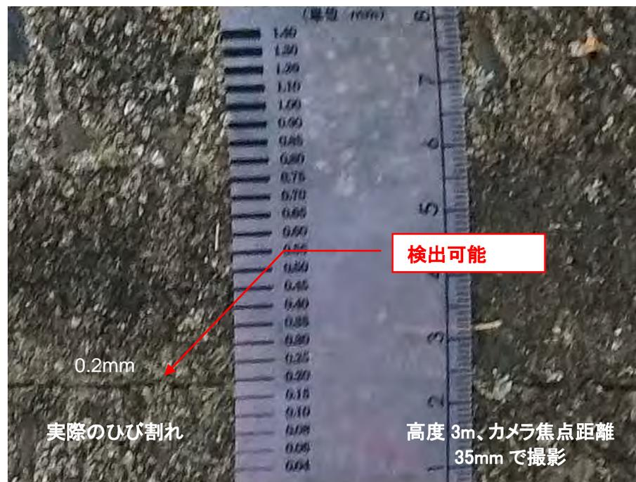
図5.3 ひび割れの検出限界調査事例
