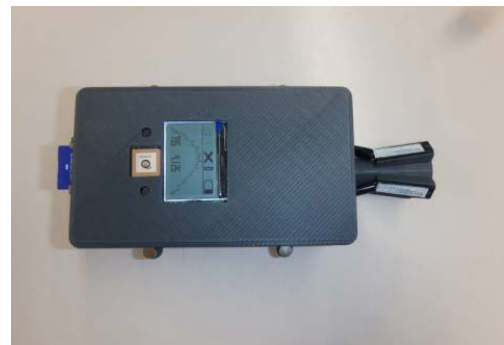
写真 28. 1 可搬型超音波センサ（試作器 2.5）
