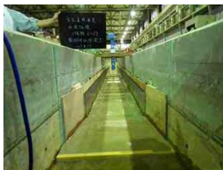
鋼矢板水路模型（試験 C-2）
