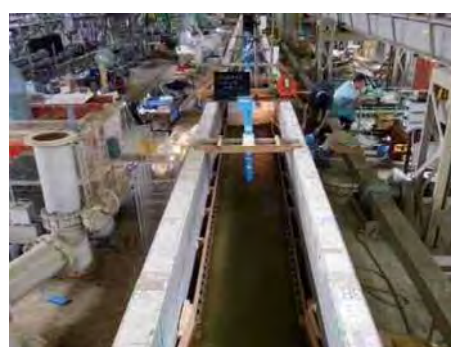
鋼矢板水路模型（試験 C-2）
