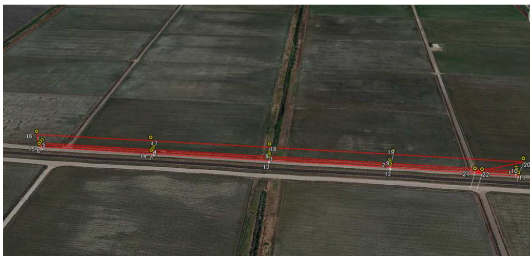
上図：撮影計画図（平面図：水路を挟んで2コースの撮影） 下図：撮影計画図（KML を利用して鳥瞰視：水路の上空を2段撮影）
