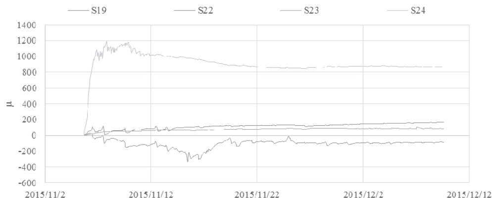
図（７）－２８ 主鉄筋のひずみ
