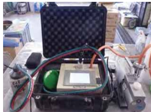
b) トレント測定状況
