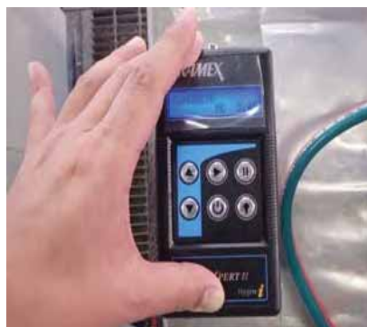
a) 含水率測定状況
