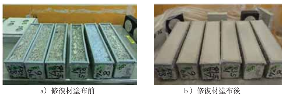
写真 5 修復材塗布前後の状況
