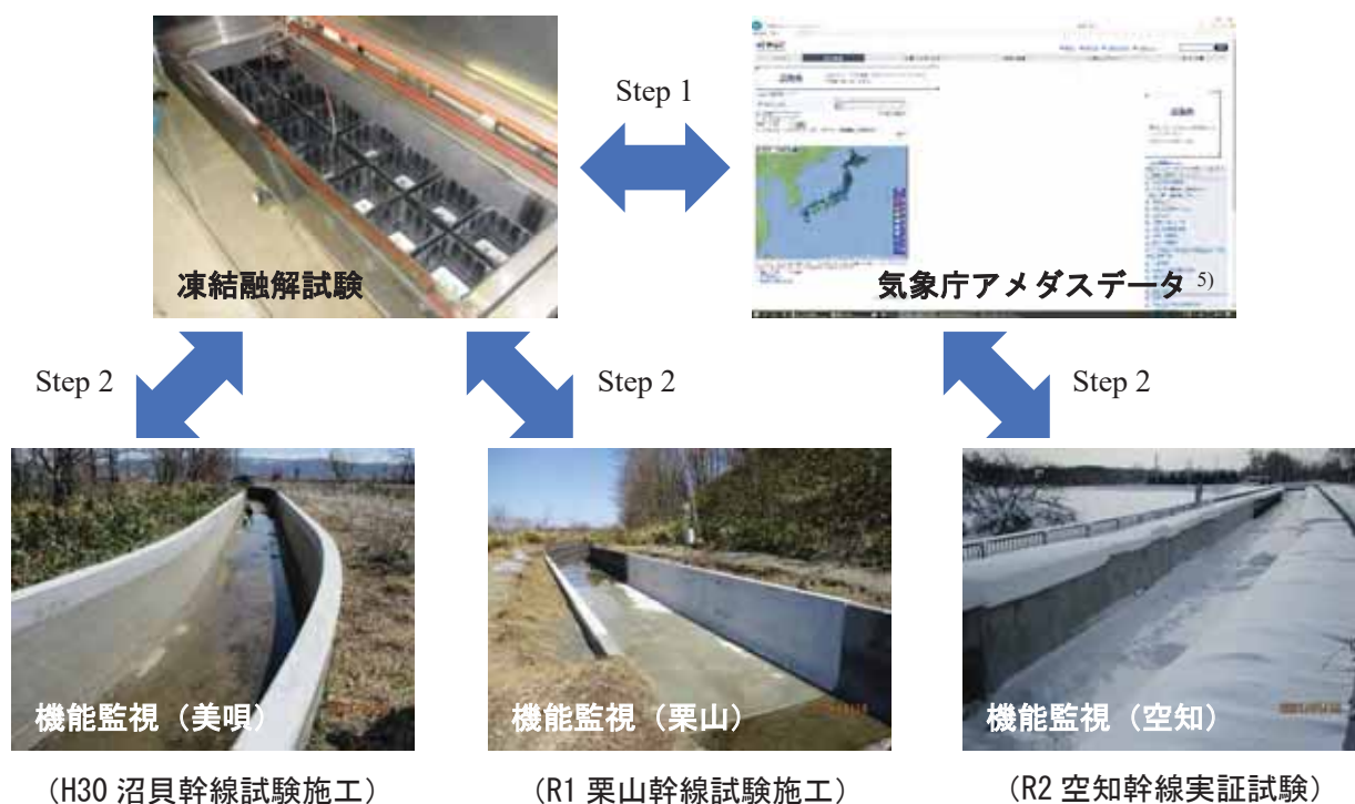
図－２ 耐用年数の試算の手順のイメージ (機能監視結果 (現地温度データ) を用いた試算精度の向上)
