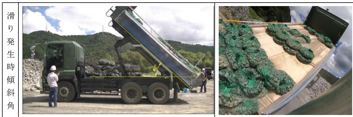
図 7 側面写真によるせん断角度の測定結果
