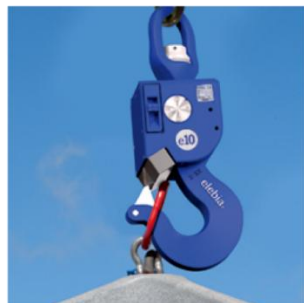
図 22 オートフックの吊り上げ機構 1)
