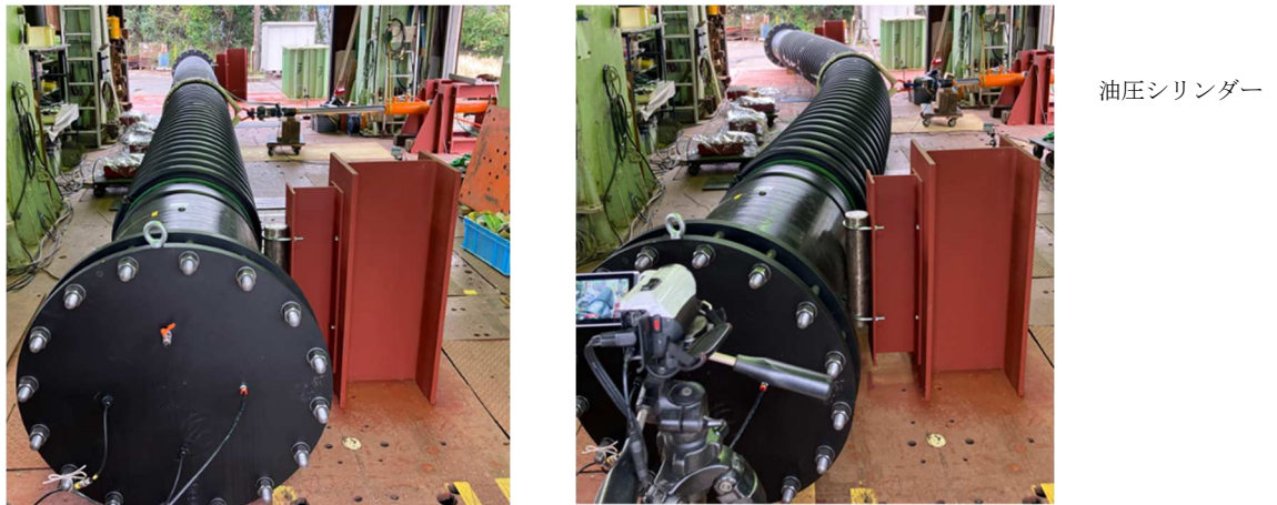
図 5-3-2 3点曲げ試験方法
