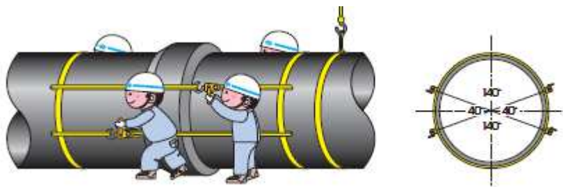
図 4-3-4 接合状況(φ 1350～φ 1500 : 4 点接合)
