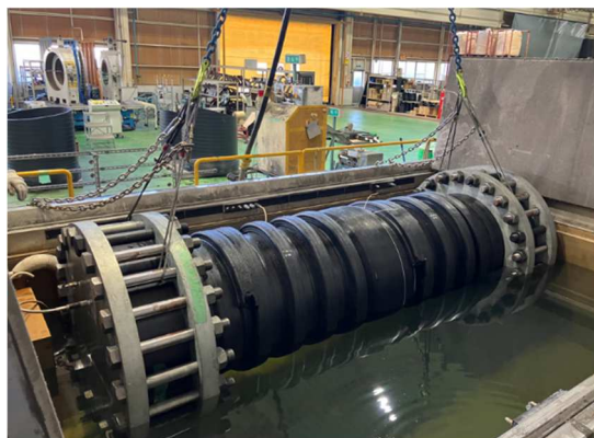
図 17. 熱間内圧クリープ試験
