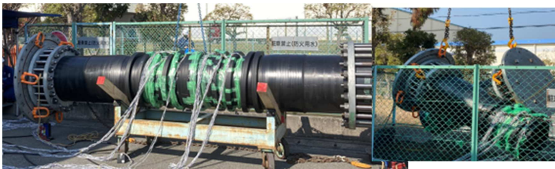
図 7. 破壊試験試験体
