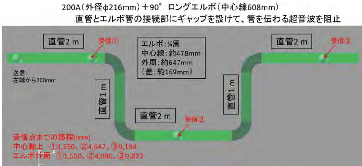
図 32 呼び径φ200mm 長さ 10m のエルボモデル (FEM 解析モデル)
