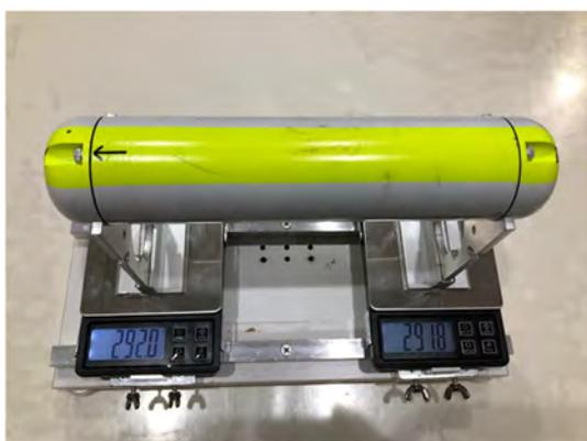
写真 11 左右の秤で前後の重量計測
