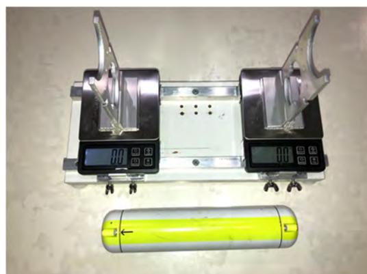
写真 10 秤を載せてゼロ点調整
