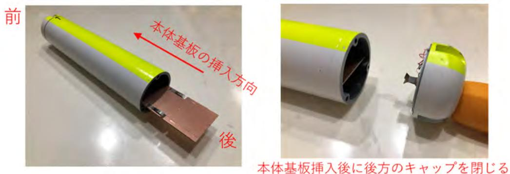
写真 8 本体基板の挿入と固定
