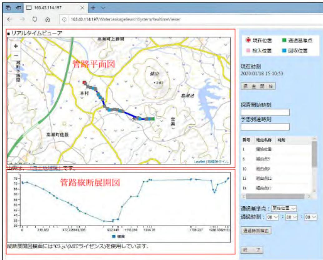
図 36 3D管路図をベースに作成したリアルタイムビューアの一例
