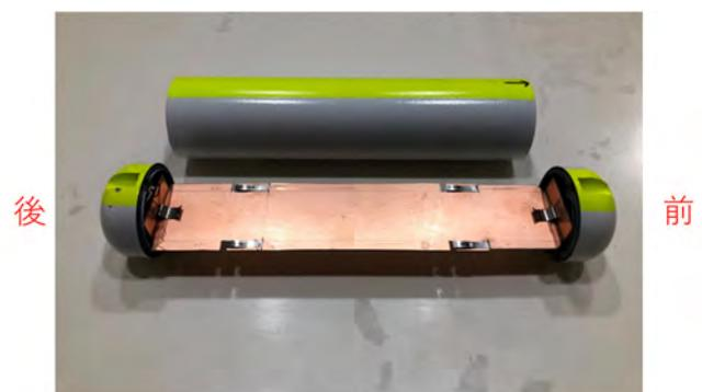
写真 7 ロボット基板の固定金具
