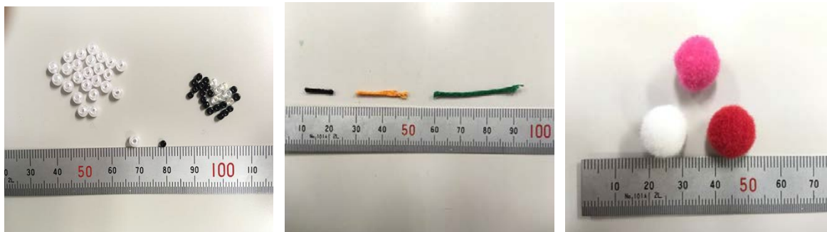
疑似塵芥 ビーズ 2mm・4mm、刺繍糸 10mm・20mm・30mm、毛綿 φ10mm
