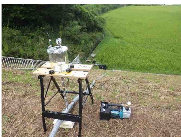
図1.6-11 改良後の装置(左)真空ポンプ、貯水槽部分(右)持ち運ぶ部品
