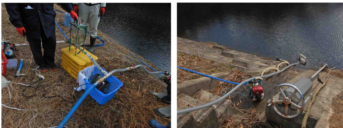
図 1 . 6 - 8 現地実験の様子 (左)真空ポンプ、貯水槽部分(右)ため池側
