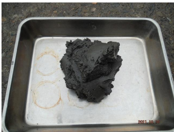
(a) 貯泥水槽から採取した底泥土
