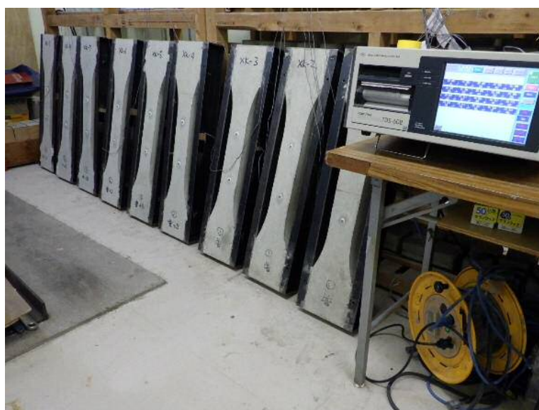
写真 1 拘束形鋼のひずみ測定状況
