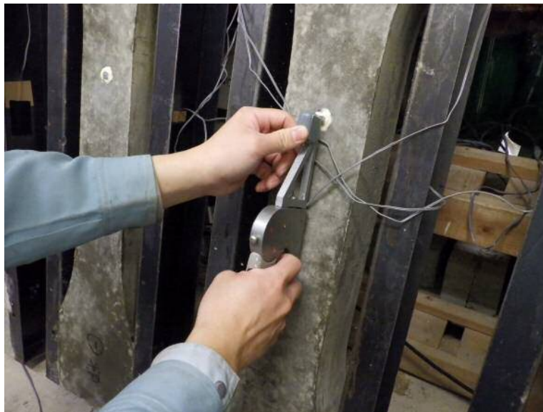
写真 2 拘束収縮ひずみ測定状況
