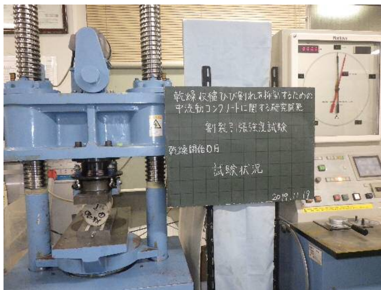
写真 4 割裂引張強度試験状況
