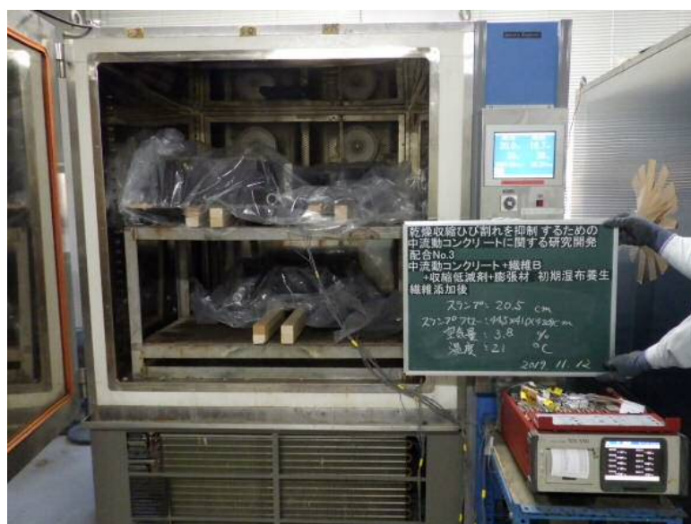
写真 7 リング試験測定状況
