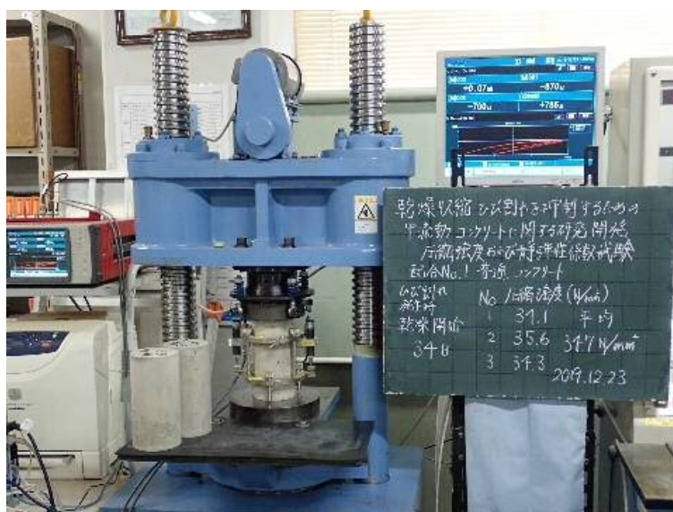
写真 5 圧縮強度および静弾性係数試験状況
