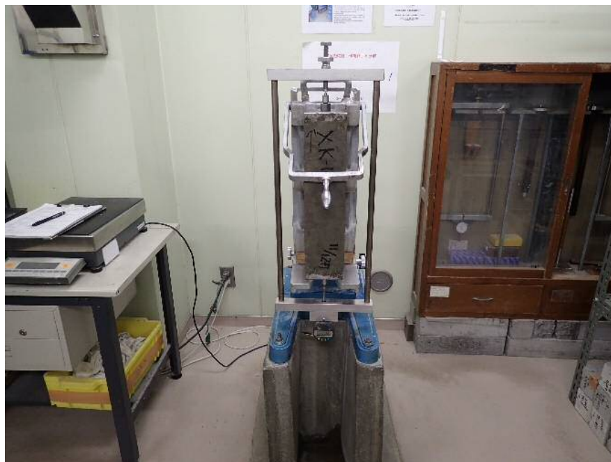
写真10 膨張コンクリートの拘束膨張および収縮試験状況
