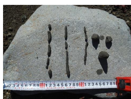
(46) 指頭法による土性確認
