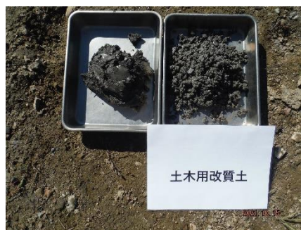
(48) 原泥と土木用改質土
