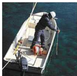
図-5 従来の深浅測量（重錘法） 図-6 平均断面法（中） 図-7 マルチビーム測深の概念
