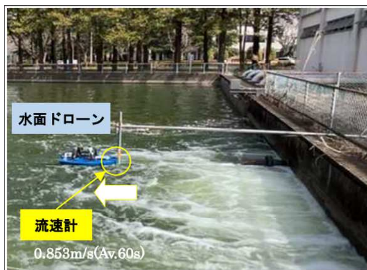
図-24 姿勢保持性能試験の実施状況（2022年3月）
