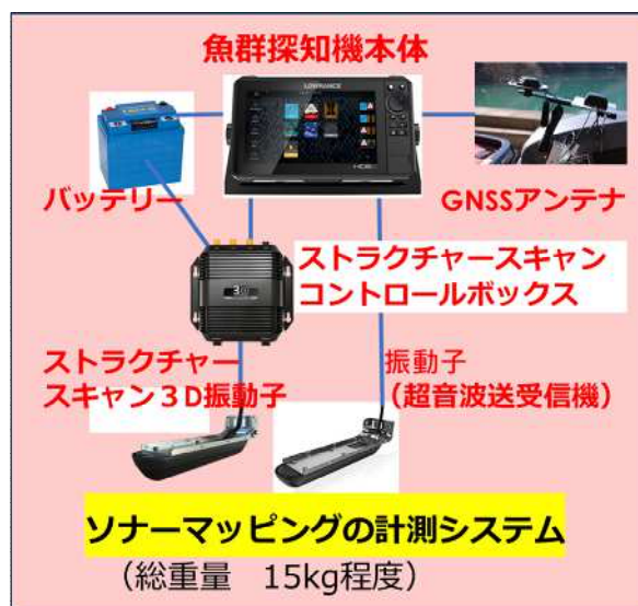
図-11 ソナーマッピングの計測システム（使用計器類一式）
