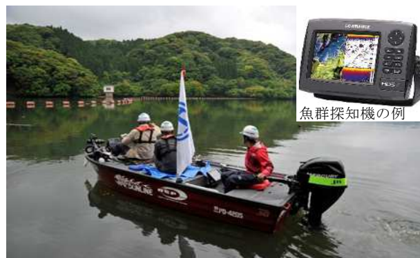
図-8 ソナーマッピング調査船の例
