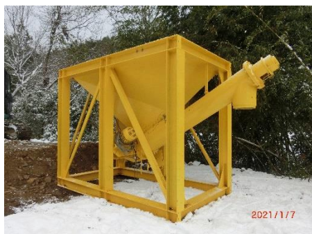
(5) 泥土供給装置
