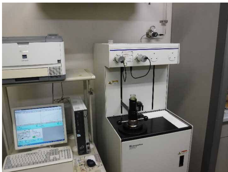
写真 9 細孔径分布測定（水銀圧入法）状況
