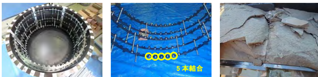
図 1-6-4-1 平成 27 年度円環外圧強度試験実施状況
