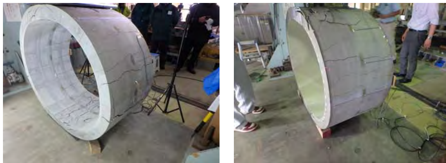
図 1-6-4-4 円環外圧強度試験ひび割れ発生状況
