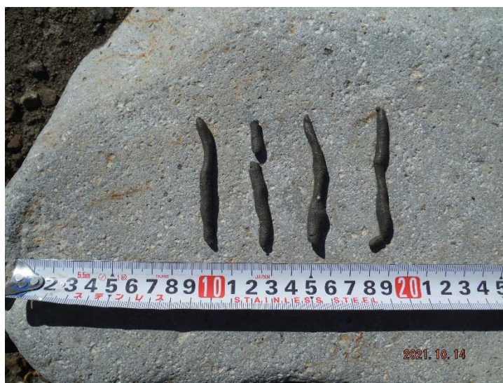
写真 1. 7-12 指頭法による土壤用改質土の土性判定（新潟貯水池）
