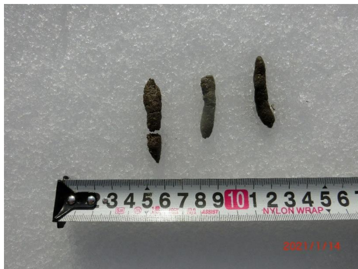
写真 1. 7-11 指頭法による土壤用改質土の土性判定（山口ため池）
