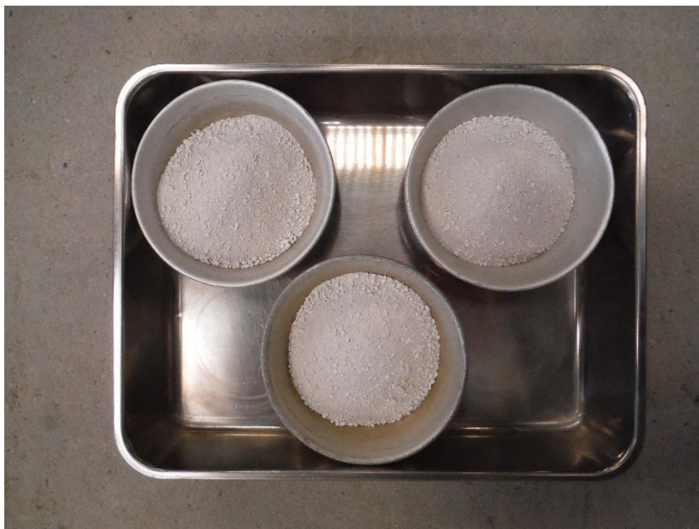
写真 1. 6-6 アルミ容器に入れた再生半水石膏粉の吸湿試験状況（手法 2）
