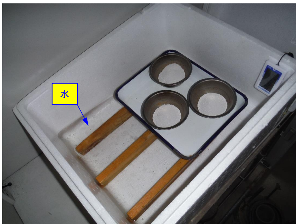
写真 1. 6-7 再生半水石膏粉の吸湿促進試験状況（手法 3）
