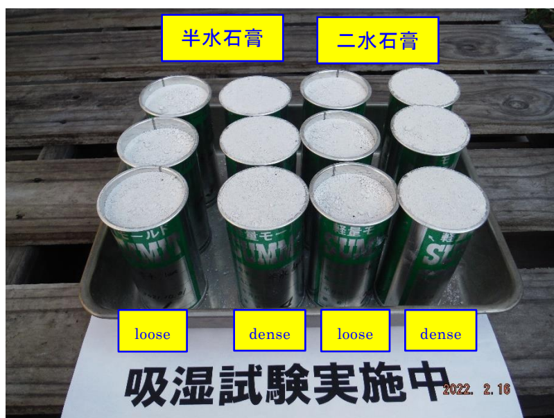
写真 1. 6-5 サミットモールドに詰めた再生石膏粉の吸湿試験状況（手法 1）
