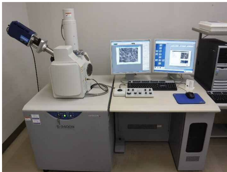
写真 8 走査型電子顕微鏡観察 (SEM-EDS 試験) 状況
