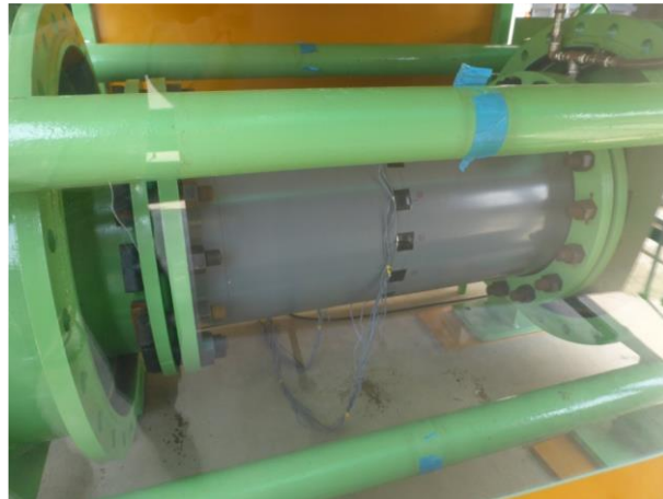
図 3.3.3 呼び径 450PVC 管(VU)
