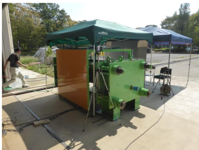
図 3.3.1 内圧負荷試験装置
