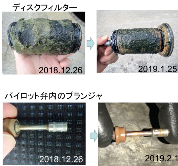
図 38 0.9%酢酸による洗浄試験によるフィルターとパイロット弁の内部の変化の様子
