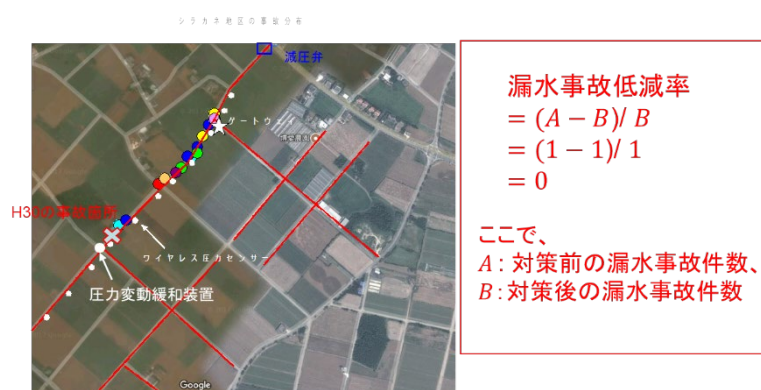
図 40 宮古島地区の圧力変動緩和装置の設置場所と漏水事故発生個所の位置関係
