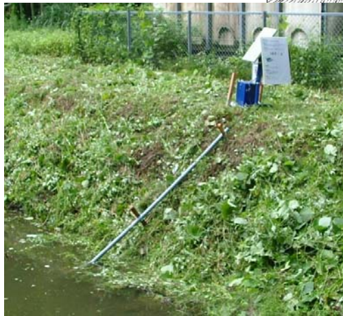
ため池位置と水位計測機器
