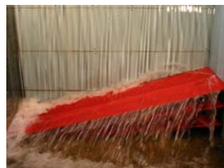
写真-4 傾斜板の流況
