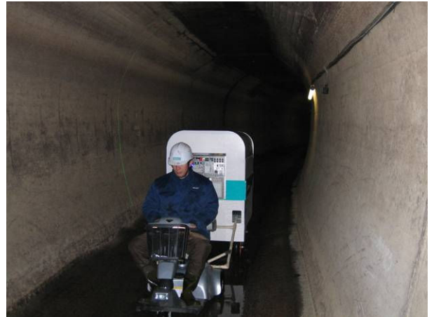
CCDラインカメラ法による開水路壁面計測状況 レーザースキャニング法によるトンネル壁面計測状況
