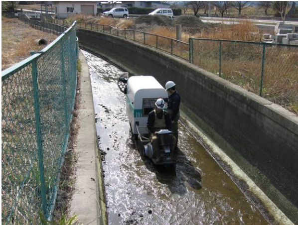
CCDラインカメラ法による開水路壁面計測状況 レーザースキャニング法によるトンネル壁面計測状況
