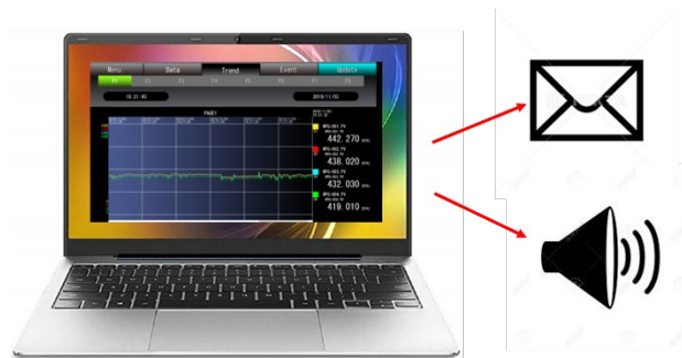
図45 管理者へ漏水を知らせる仕組み
