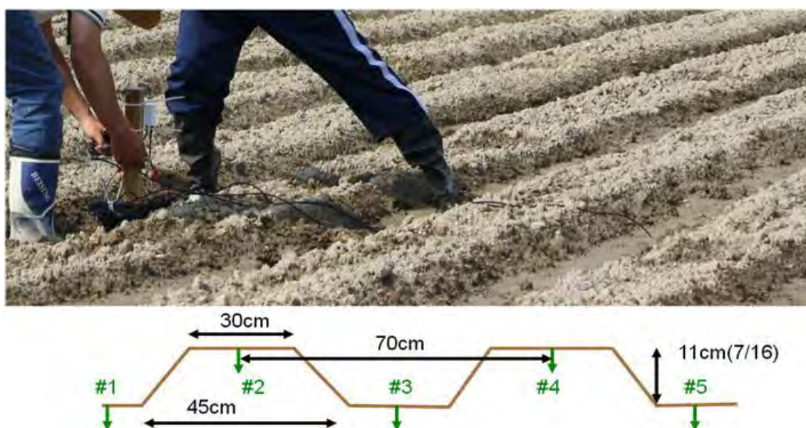
図－3 データロガーと土壌水分センサの設置（2009年7月4日）
