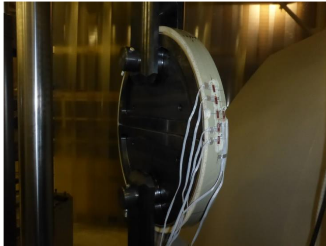
図 3.2.9 試験 No.FRPM-N1（ノッチ 80° 位置）の設置状況
