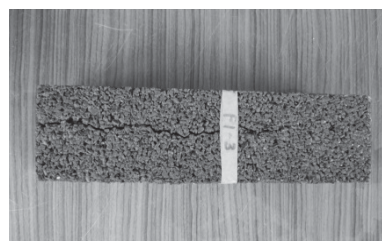
(c) P1 の 80 サイクル時の崩壊状
