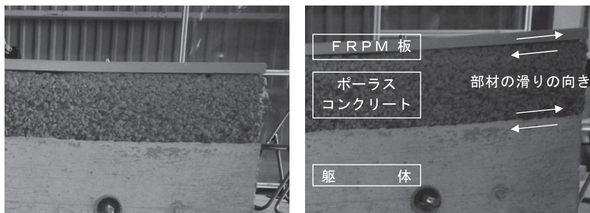
図（４）－５ 部材境界面における滑り・開口（ポーラスコンクリート厚さ t=70\text{mm} ） （左：載荷前，右：載荷後）
