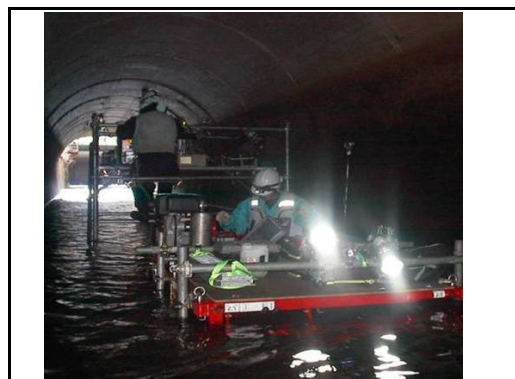
④自走台車による減量通水調査（レーザー計測）
