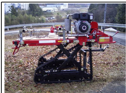
①レーザー・レーダ技術を搭載用の自走台車
