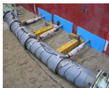
図 4.1 小口径模型実験管路
