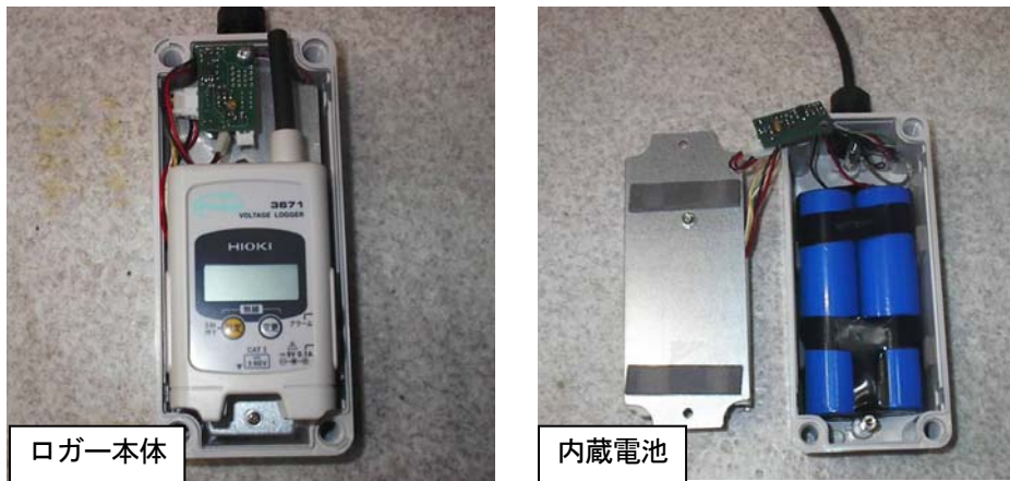
図- 3.3 データロガー内部写真
