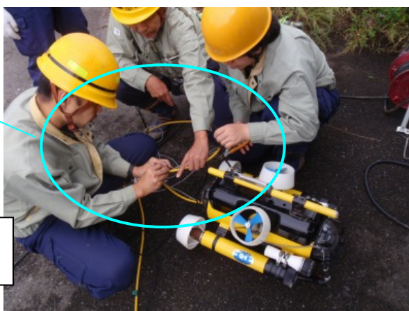
図- 2.1 改造前における AE センサケーブルの本体ケーブルへの取付け
