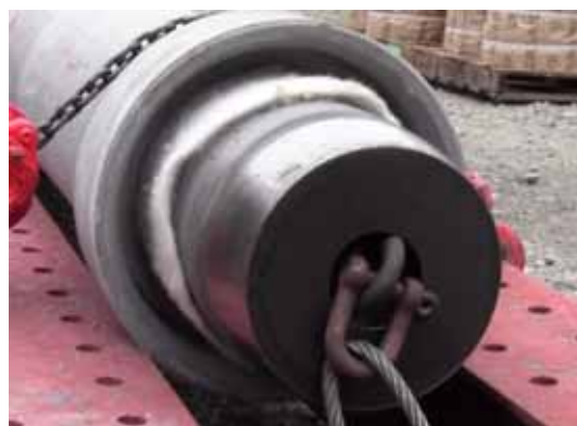
写真 6-20 ファイン管の抜け出し
