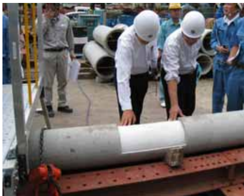
写真 4－2 中込め状況の確認
