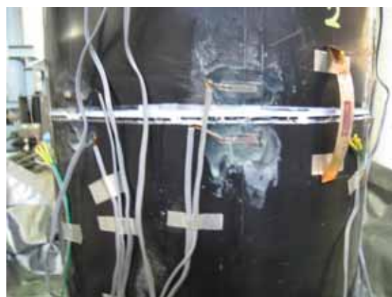
写真3-2 水圧引張り試験（PBT）
