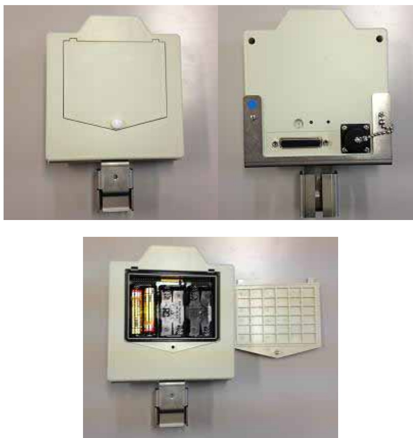
センサーノード（温度、湿度、照度、土壤水分センサー32ch）外観
