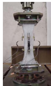
写真－7 疲労試験試実施状況
