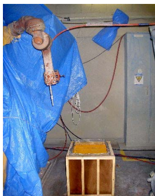
写真－6 WJによる摩耗試験概要
