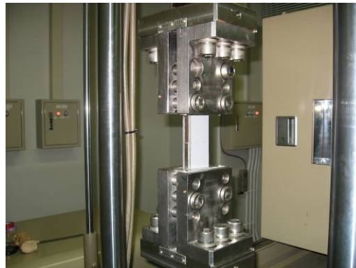
写真-2 ひび割れ追従試験（例）
