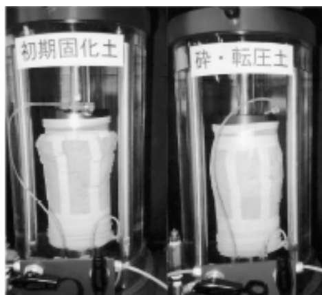
三軸圧縮試験による供試体の破壊モード
