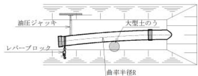
図 5-4 現地曲げ配管
