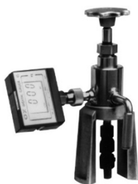
図-13 建研式付着力試験機
