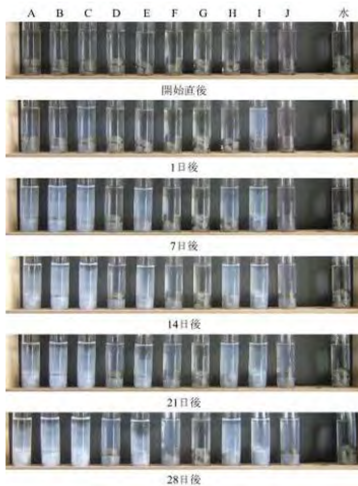
図－4 ろ過液の反応性確認試験の結果（常温乾燥固形分を使用）
