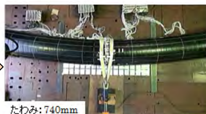
図-1.19 3点曲げ試験状況
