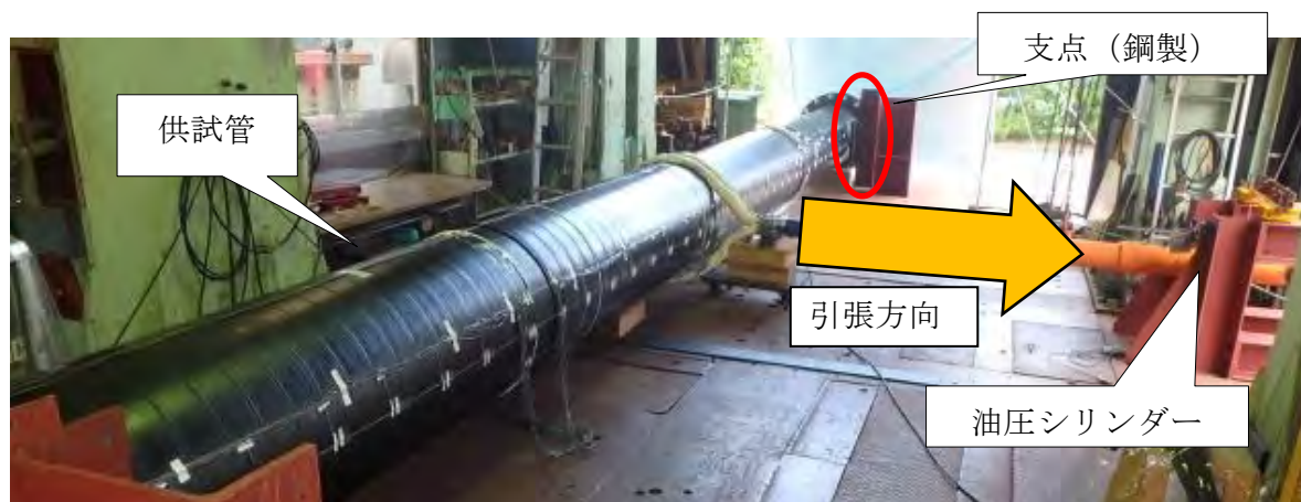
図-1.18 3 点曲げ試験(供試管:PE-GF 直管)
