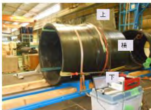
図-1.30 EF 融着試験(φ1350) および強度試験位置
