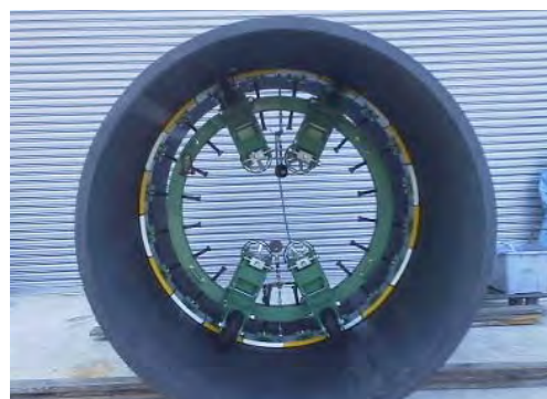
図-1.31 EF 継手部 継ぎ目試験
