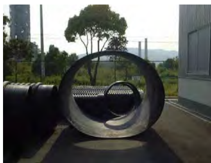
図-1.9 PE 管の自重変形
