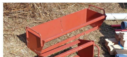
図-19 薄層段切り工法用鋼製型枠概要図
