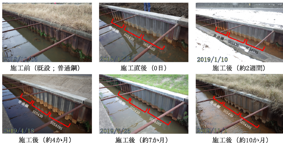
図 1.8.6 普通鋼およびステンレス矢板の様子（新潟亀田郷大石：暴露期間 0.5 年）
