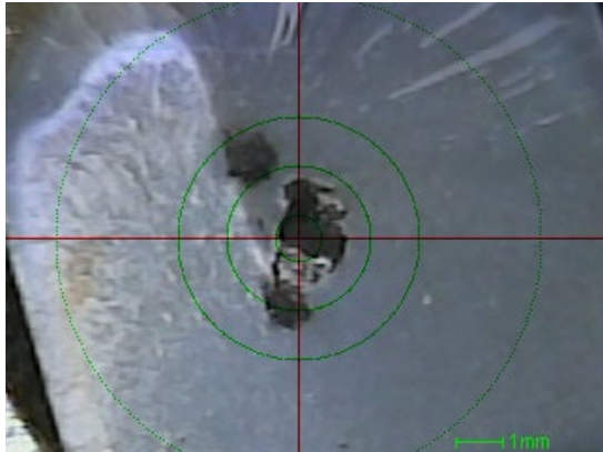
図 31 No.1 異物に X 線を照射
