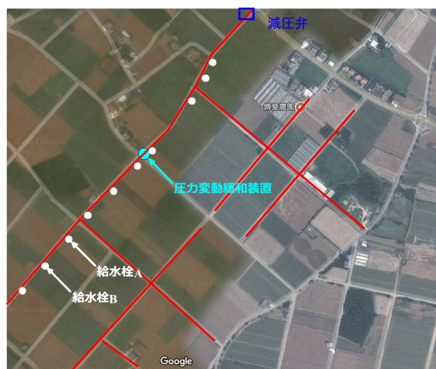
図 42 宮古島地区の実証試験地区における給水栓と圧力変動緩和装置の位置
