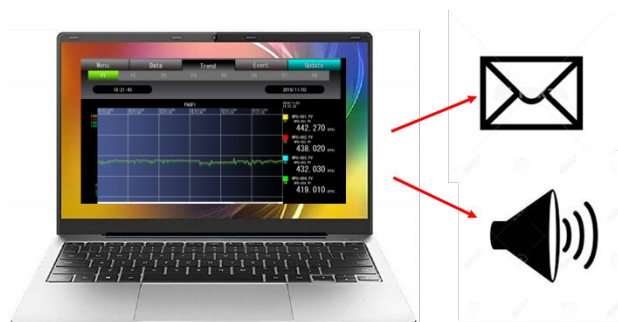
図45 管理者へ漏水を知らせる仕組み
