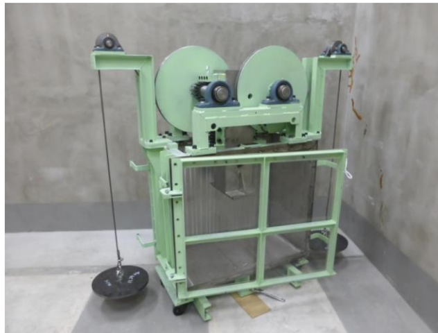
図 5.2 外圧クリープ試験装置外観（前面のアクリル板が開いた状態）
