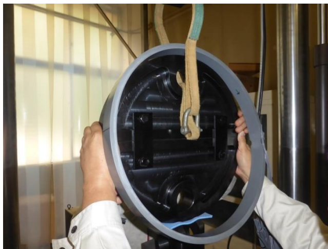
図 3.2.3 \phi 450 PVC リングを分割板にセット
