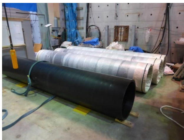
図 1.3.4 PE-GF 管 (JIS K 6799)
