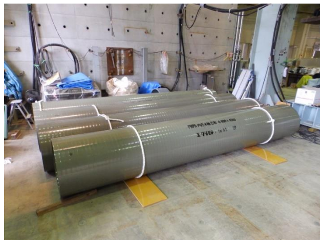
図 1.3.2 FRPM 管 (JIS A 5350)
