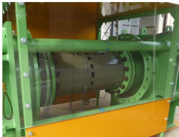
図 3.3.4 呼び径 450FRPM 管(内圧 3 種)
