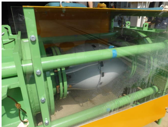
図 3.3.5 呼び径 450PVC 管(VU)漏水状況
