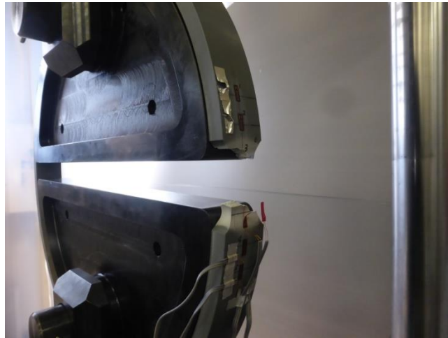
図 3.2.6 試験 No.PVC-N1（ノッチ 90° 位置）の破断状況
