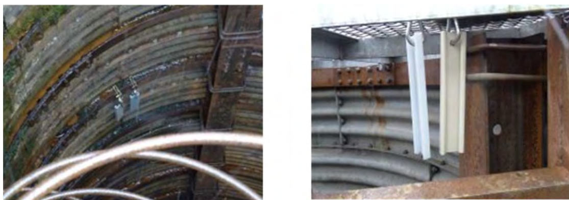
図 1-6-1-3 暴露供試体の配置状況
