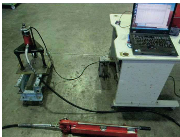
写真 2 载荷方法の試験状況 (左: 油圧式载荷, 右: ねじ式载荷)
