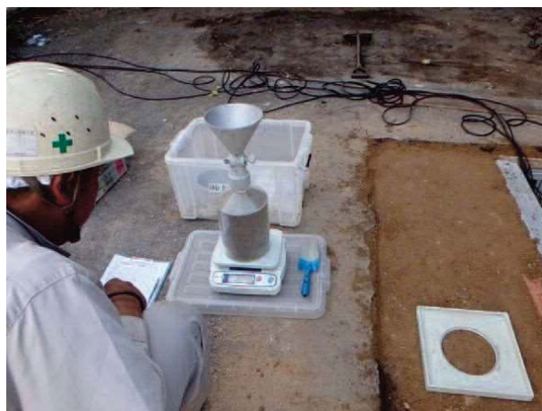
写真 2 9 砂置換法土密度試験状況
