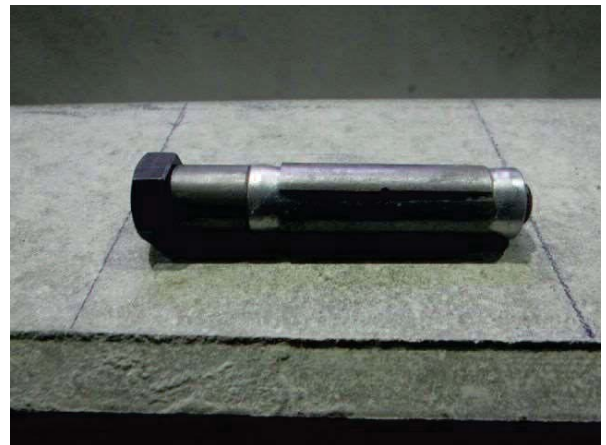
写真 9 ひび割れ誘発アンカー
