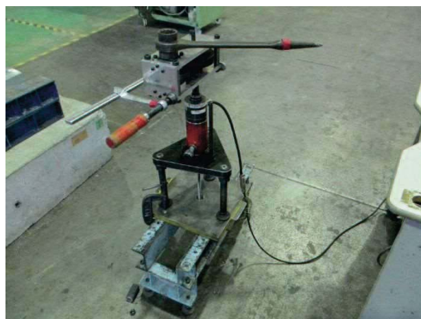
写真 2 载荷方法の試験状況 (左: 油圧式载荷, 右: ねじ式载荷)
